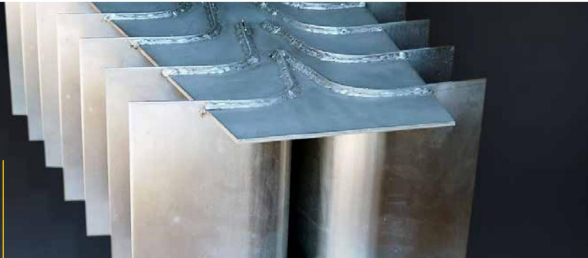
Se construyen a partir de placas curvadas ubicadas de manera tal que dividen gradualmente el flujo ingresante. Así reduce su velocidad drásticamente y cambian el momento. Favorecen una rápida separación de gases. Reducen la agitación y el splash provocado por ingresos de slug y minimizan el rearrastré de gotas en el gas.
